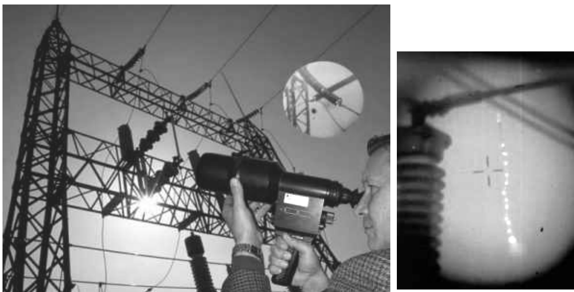
Рис. 6.15. Внешний вид электронно-оптического дефектоскопа "Филин-6" и полученная при помощи него картинка.
