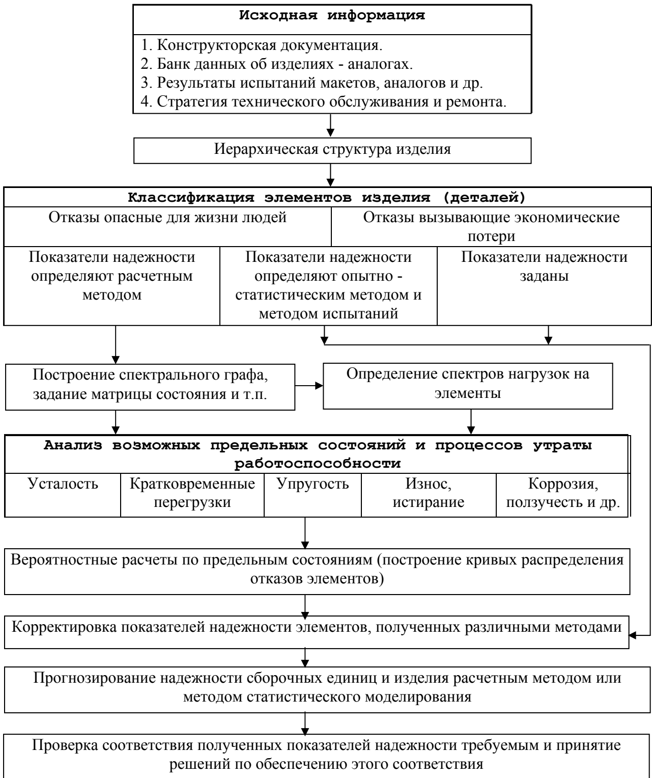
Рис. 3.1. Блок - схема прогнозирования надежности изделий при проектировании
